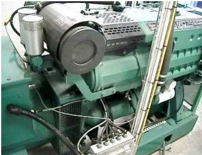
Bild 3.x Värmewäxlare (Grön,mitten höger). EDI vit nederst. Generator (vänster)
